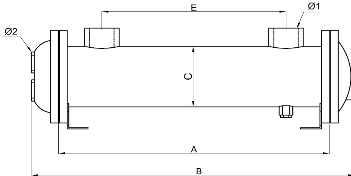
Las series 114 y 140 están construidas con tubos y placas de cobre. Separadores en latón. Cuerpo de acero. Tapas de hierro fundido. Modelos en 1 - 2 y 4 Pasos.
