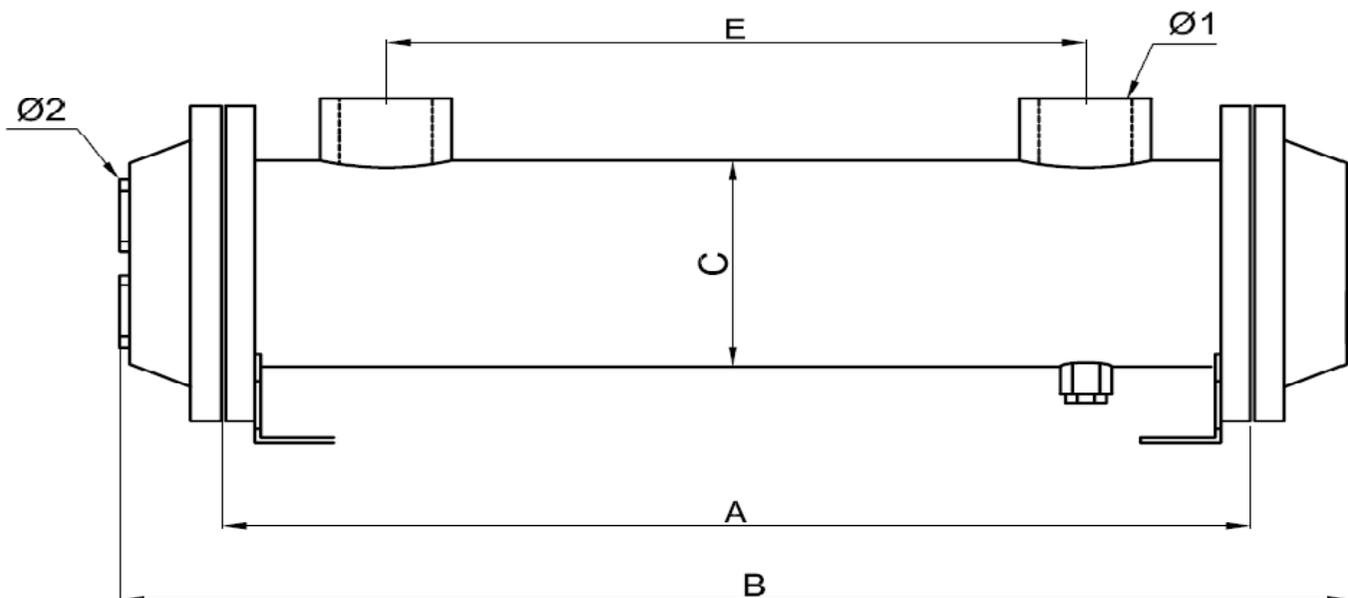
Serie 150 y 200 construida con tubos de cobre mandrilados a placa de acero inoxidable. Haz de tubos fijo o flotante
