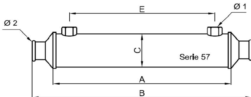
Serie construida con tubos y placas en cobre.
